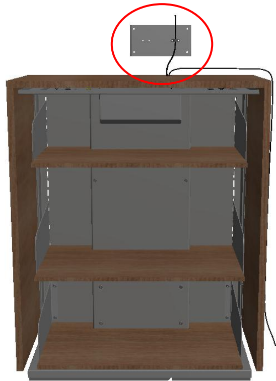
Avlastning til strømledningen monteres på veggen.
